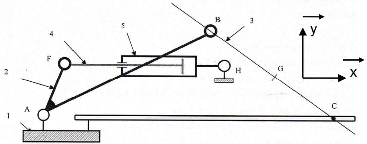
La porte d'un autobus bénéficie d'un système d'ouverture pneumatique. Le vérin 4+5 « pousse » le volet 2 et le met en rotation autour de A. Le volet 3 est alors entraîné, le point C restant sur la droite (C,x) grâce à la liaison ponctuelle.
